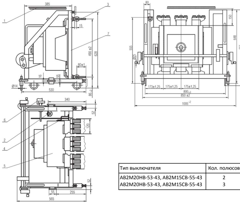
1 - электроизоляционный щиток; 2 - соединитель электрический; 3 - ножи врубные; 4 - механическая блокировка; 5 - выключатель ВА53-41А, ВА55-41А; 6 - упор на стенке РУ; 7 - каркас
