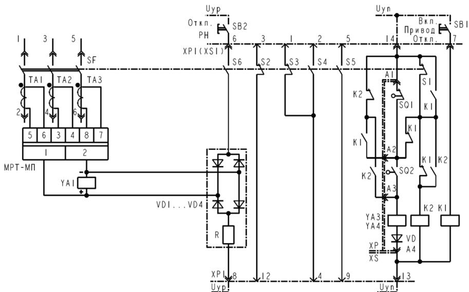
**Рисунок В.7 - Схема электрическая принципиальная выключателей переменного тока типов АВ2М15, АВ2М20 выдвигного исполнения с электроприводом и независимым расцепителем**
