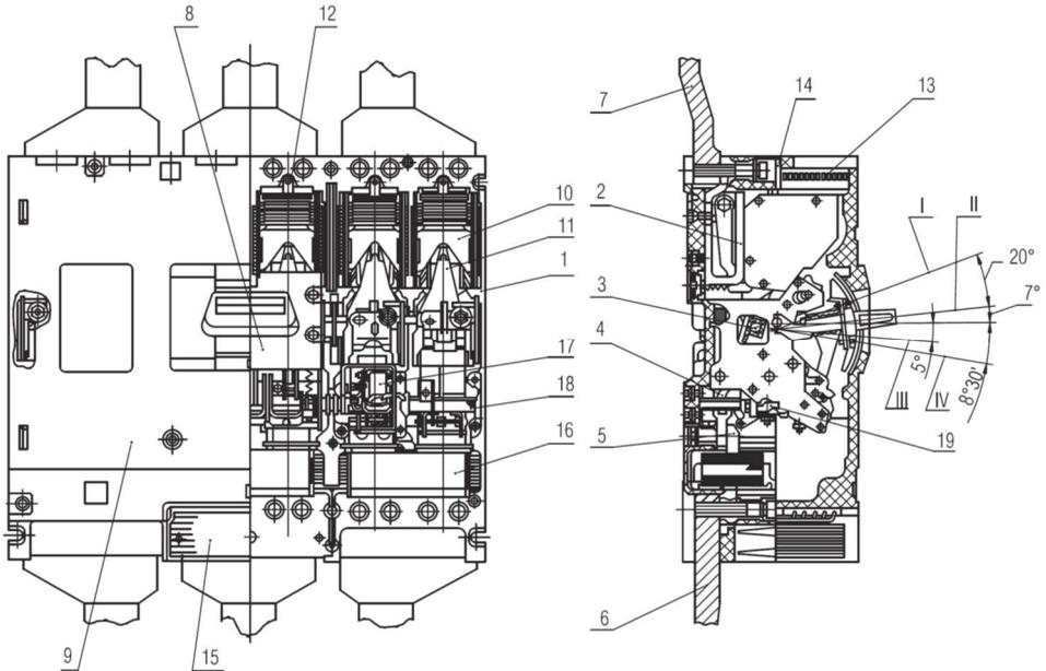
1 – корпус; 2 - контакты малоподвижные; 3 - траверса изоляционная; 4 - соединение гибкое; 5 – шина; 6, 7 – выводы; 8 – рукоятка; 9 – крышка; 10 - камеры дугогасительные; 11 - контакты подвижные; 12 – винт; 13 – искрогаситель; 14 – пластина; 15 - максимальный расцепитель тока (МРТ); 16 - трансформаторы тока; 17 - исполнительный электромагнит МТЗ; 18 - электромагнитные расцепители; 19 - рейка отключающая.
