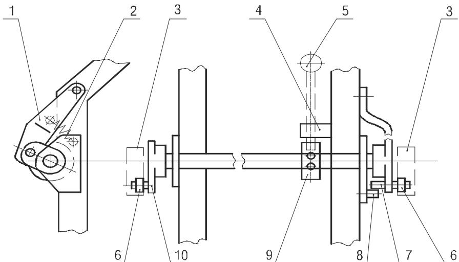
1 – скоба; 2 – пружина; 3 – опорная скоба (в ячейке); 4 – упор; 5 – рукоятка; 6 – ролик; 7 – палец; 8 – упор; 9 – диск; 10 – эксцентриковый кулачок
