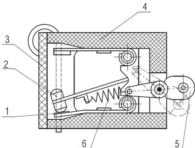
1 - контакт вспомогательный; 2 - контакт подвижный; 3 – крышка; 4 – корпус; 5 – рычаг; 6 - пружина
