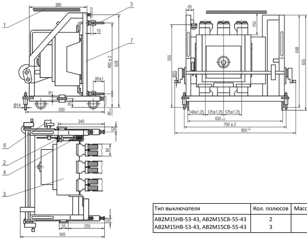
1 - электроизоляционный щиток; 2 - соединитель электрический; 3 - ножи врубные; 4 - механическая блокировка; 5 - выключатель ВА53-41А, ВА55-41А; 6 - упор на стенке РУ; 7 - каркас
